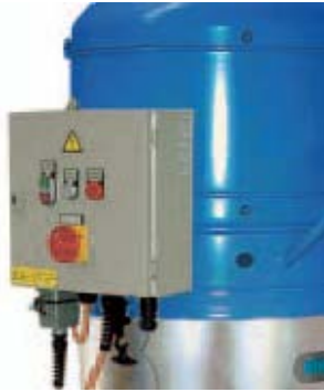
Steuerschrank für Motor, Rüttler und Füllstandssensor, sowie Fernsteuerung über Maschinenkontakt
